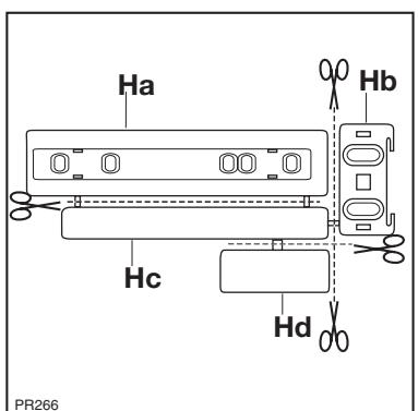
Приложите направляющую (Ha) к внутренней стороне дверцы кухонного шкафа сверху и снизу, как показано на рисунке, и отметьте положение наружных отверстий. Просверлив отверстия, прикрепите направляющую с помощью прилагаемых винтов.
