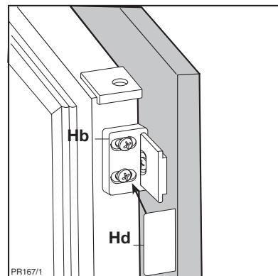
Установите прибор сбоку от кухонного шкафа, закрепите держатель (E-F), отрегулируйте расстояние и зафиксируйте с помощью винтов (как показано на рисунке). Установите крышку (D).
