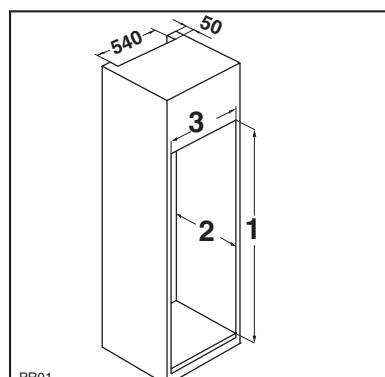
Установите прибор в нишу для встраивания таким образом, чтобы он прилегал к внутренней поверхности кухонного шкафа со стороны, противоположной той, к которой у него установлены петли дверцы. Вставьте прибор так, чтобы верхняя полоса уперлась в кухонный шкаф (1); убедитесь, что нижняя петля находится на одной линии с поверхностью кухонного шкафа (2).
